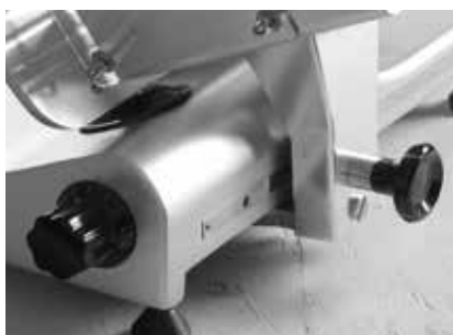
Carrello con sistema di bloccaggio
